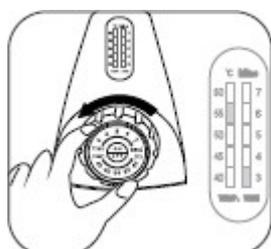
Gire el mando hacia la izquierda para seleccionar la temperatura deseada (40°C, 45°C, 50°C, 55°C, 60°C). El indicador de temperatura mostrará la temperatura de limpieza seleccionada. Gire el mando hacia la izquierda para ajustar la temperatura deseada.
