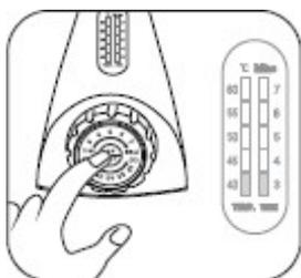
Conecte el aparato a la red eléctrica (el ajuste automático del aparato es de 3 ciclo de limpieza de minutos y **40°C**).
