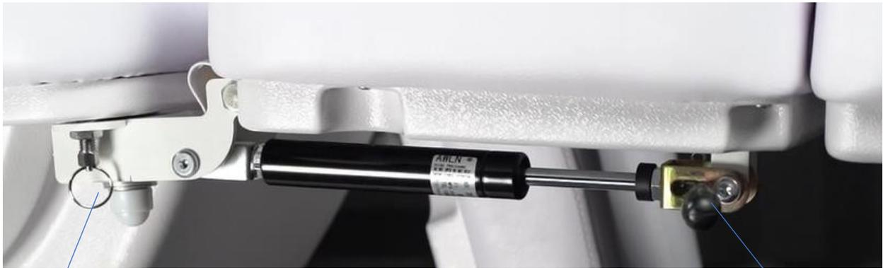
**Mécanisme de basculement latéral du repose-pieds    Levier d'élévation/abaissement du repose-pieds**
