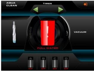
Öffnen Sie dann die hintere Tür der Maschine und entfernen Sie das Schmutzwasser aus der Flasche. Folgen Sie der Pfeilrichtung, reinigen Sie das Schmutzwasser und setzen Sie die Flasche wieder ein, a dann verwenden Sie es weiter.
